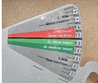
7. Una vez colocada la etiqueta, coloque el cáliper una vez más en la herramienta calibradora para confirmar que la aguja cae directamente sobre la línea negra que separa las categorías dos y tres. Si es así, entonces la actualización está completa. Si la aguja no coincide con la línea, repita el proceso y vuelva a aplicar la etiqueta.
