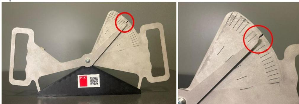
5. Retire el cáliper de la herramienta de calibración. Mueva la aguja hacia el lado opuesto para dejar suficiente espacio para aplicar la etiqueta.
