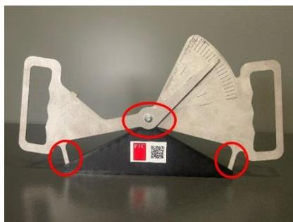
4. Usando un marcador, dibuje una línea desde la punta de la aguja del cáliper hasta el borde exterior del cáliper, esto debe extenderse más allá de las líneas grabadas en el cáliper.
