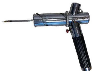
Рисунок 1.3 Интраскоп, используемый для измерения толщины шпика
