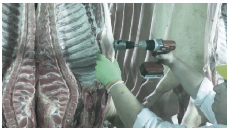
Рисунок 4.1 Пробоотборник с аккумуляторной дрелью для отбора проб
