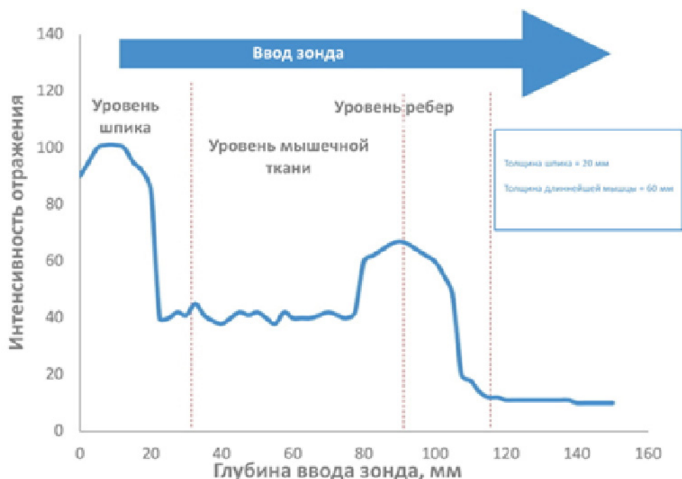
Рисунок 1.5 Профиль отражения света оптического зонда при определении толщины шпика и длиннейшей мышцы
