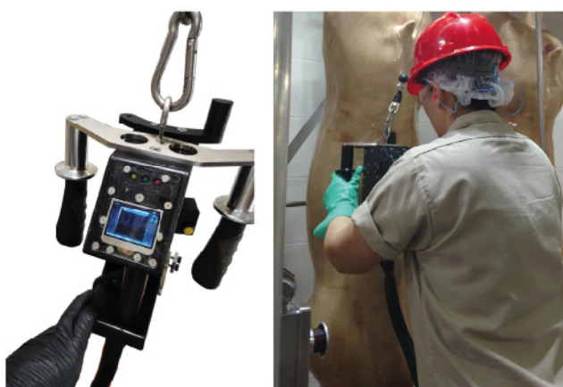
Рисунок 1.7 Ультразвуковой прибор определения качественных параметров туши
