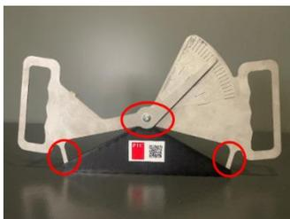
4. Usando un marcador, dibuje una línea desde la punta de la aguja del Caliper hasta el borde exterior, esto debe extenderse más allá de las líneas grabadas en el Caliper.
