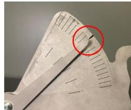
5. Retire el Caliper de la herramienta de calibración. Mueva la aguja hacia el lado opuesto para dejar suficiente espacio para aplicar la etiqueta.
