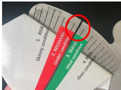
7. Una vez colocada la etiqueta, coloque el Caliper una vez más en la herramienta calibradora para confirmar que la aguja cae directamente sobre la línea negra que separa las categorías dos y tres. Si es así, entonces la actualización está completa.
