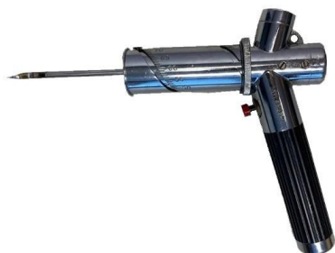
Рисунок 1.3 Интраскоп, используемый для измерения толщины шпика
