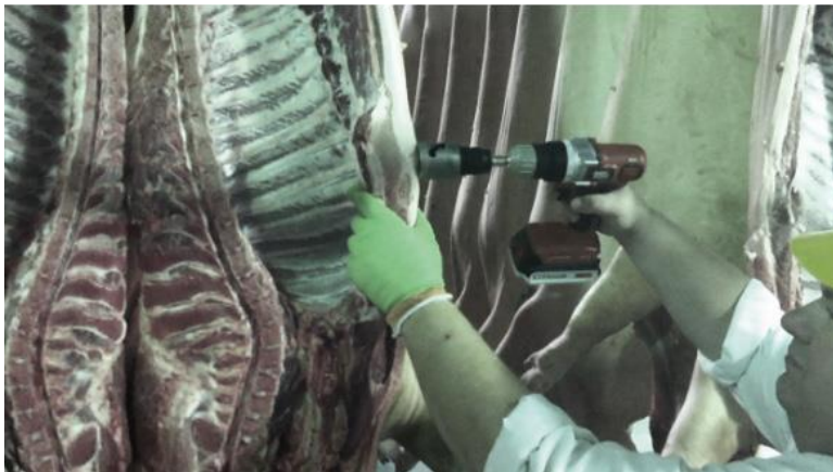
Рисунок 4.1 Пробоотборник с аккумуляторной дрелью для отбора проб
