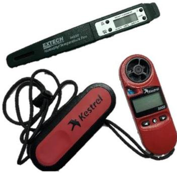
Por último, utilice y verifique los controladores, los detectores de la velocidad del aire (anemómetros) y las sondas de humedad diariamente.
